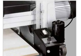
Höhenverstellung der Schleifeinheit an einer Skala ablesbar
