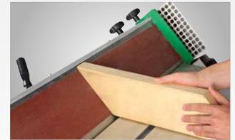
Durch das stufenlos schrägverstellbare Schleifaggregat ist die Kantenschleifmaschine für verschiedenste Schleifvorgänge wie z. B. vertikales und horizontales Schleifen verwendbar
