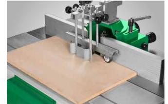
Fräsanschlag mit feineinstellbaren Aluminium-Anschlägen
