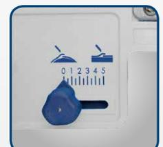
Kantenüberstand ist einstellbar, dadurch Kappen auf exakten Kantenstoß bei geraden Werkstücken und Formteilen (rund) möglich
