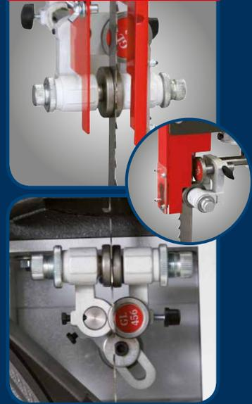
Präzisions-3-Rollen-Sägebandführung mit Führungsrollen oben und unten und Feineinstellung
