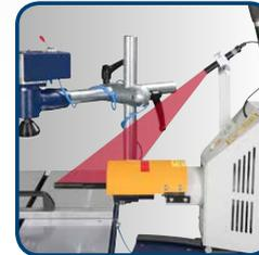
• optionale Laser-einrichtung zum Markieren der Bohrstellen
