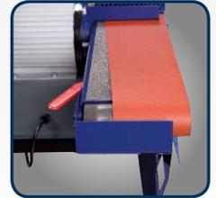
Mit Graphitbelag auf der Schleifsohle, erhöht die Gleiteigenschaft und die Lebensdauer des Schleifbandes
