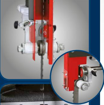
Präzisions-3-Rollen-Sägebandführung mit Führungsrollen oben und unten und Feineinstellung
