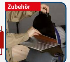
**Trennblech zum Schleifscheibenwechsel**
