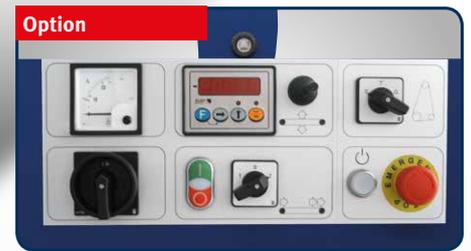
Elektronische Abmessung der Tischposition mit Digitalanzeige
