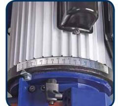
Schleifarmschwenkung über Klemmschraube und Skala von 0 - 90°
