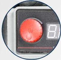
▶ Vorschubgeschwindigkeit stufenlos wählbar von 2 – 22 m/min
