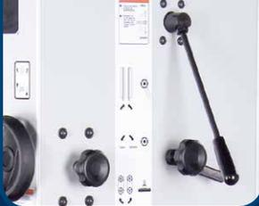
· Sägebandschnellspannung über Exzenterhebel auf der Maschinenrückseite
