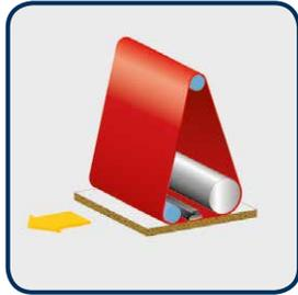
**Kombiaggregat zum Kalibrieren und Schleifen**
