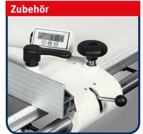
**Digitalanzeige der Arbeitsbreite am Parallelanschlag**
