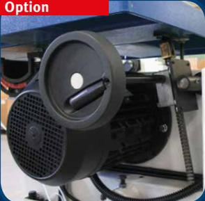
Option ab Werk: Tischsägevorrichtung mit Zahnstangenverstellung
