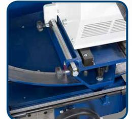
• mit präziser Linearführung mit Schmiernippel
