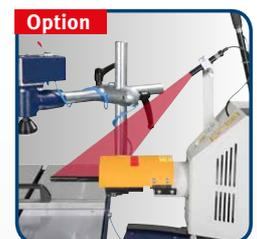
• optionale Lasereinrichtung zum Markieren der Bohrerstellung
