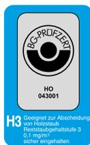
alle Anlagen staubgeprüft nach H3, Reststaubgehalt unter 0,1 mg/m<sup>3</sup>
