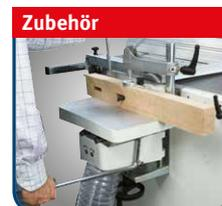
Option Langlochbohrereinrichtung mit Wescott-Bohrfutter 0-16 mm
