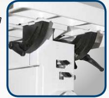
▶ Sägeband-Präzisionsführung oben und unten
