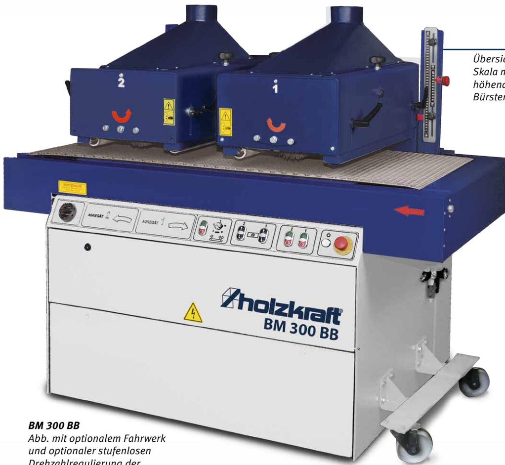
Übersichtliche Skala mit Tischhöeanzeige der Bürsteneinheiten
