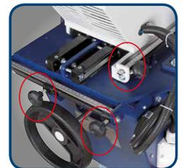
• Klemmanschläge ermöglichen die einfache und schnelle Einstellung des Bohrkopflaufs
