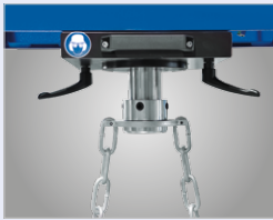
Kette für Tischhöhenverstellung über stabilen Flansch am Zylinder befestigt
