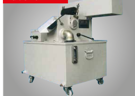
Magnetabscheider und Kühlsystem
