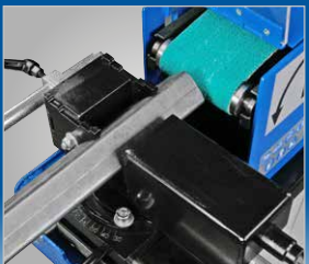
Abb. zeigt Rückseite zum Entgratschleifen mit praktischer Werkstückauflage und Späneauffangbehälter
