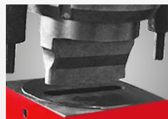
▶ optionale Stanzeinrichtung für große Durchmesser
