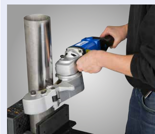
Vertikales Rundmaterial satinieren
