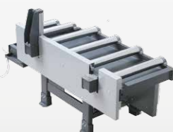
2000 x 800 mm motorische Zufuhr-Rollenbahn (Art.-Nr. 3649505)
