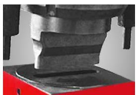
► Optionale Stanzeinrichtung für große Durchmesser
