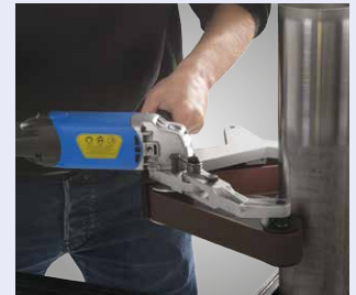
Optimal zum Schleifen und Polieren von Rohrkonstruktionen
