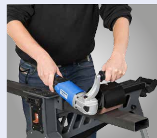
Satinieren von flachem Material
