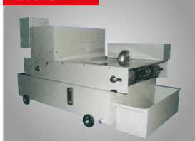
automatischer Papierbandfilter und Kühlsystem
