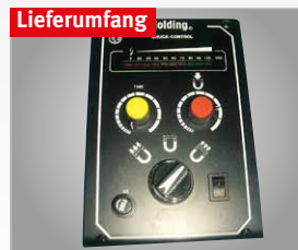
Automatischer Entmagnetisierer für Magnetspanner
