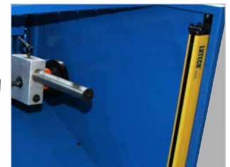
▶ Hinteranschlag mit Lichtschranke
