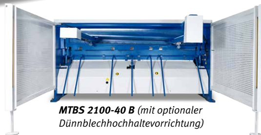
Option Pneumatische Dünnblechhochhaltevorrichtung (Option)
