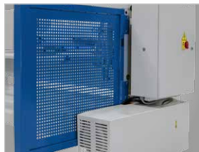
Rückraumsicherung nach CE mit Seitenblechen und Lichtschränke
