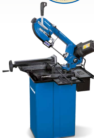
MBS 155 K - serienmäßig mit Unterbau, Kühlmittleinrichtung und Kühlmittelleitblech
