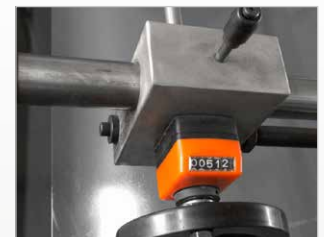
▶ Manueller Hinteranschlag mit millimetergenauer Justiermöglichkeit
