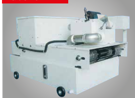
automatischer Papierbandfilter mit Magnetabscheider und Kühlsystem
