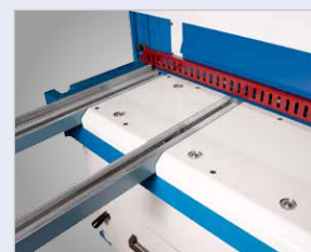
Arbeitsplatz mit Auflagearmen und Transferkugeln
