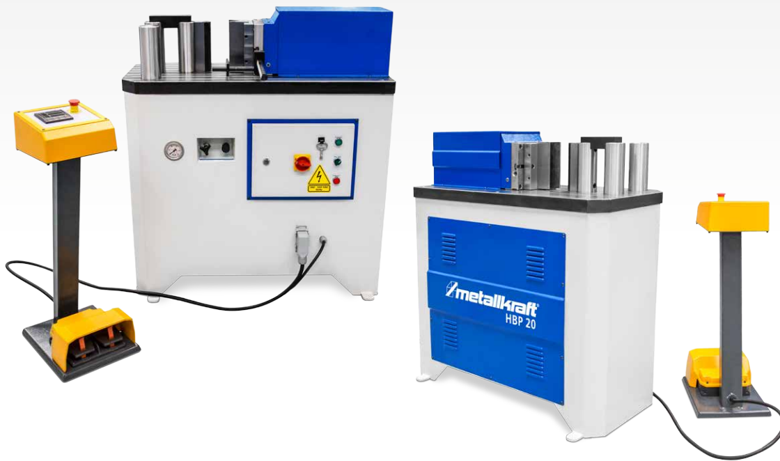
► Mit Schnellwechselaufnahme und Seitenanschlag mit Skala
