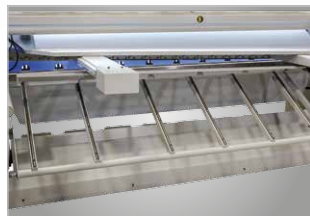
Pneumatische Blechhaltevorrichtung mit Wahlhebel für die Richtung der Blechrutsche. Der Bediener kann wählen ob der Abschnitt in den Rückraum oder zur Bedienerseite fällt
