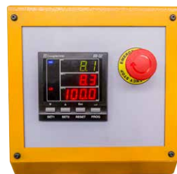
► Bedienpult mit Digitalanzeige und NOT-AUS Schalter
