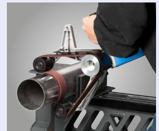
Nur zwei Arbeitsschritte notwendig für 360° Umfangschleifen
