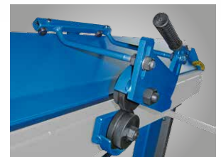
Rollschere ▶ mit Handhebel zum Abschneiden des fertigen Werkstückes
